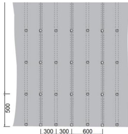
A) / B) Уложить строительную плиту на пол и крепко прижать к поверхности, зафиксировав ее соответствующими шурупами для дерева и крепежными шайбами Тускос. Используемые шурупы должны проникать в основание как минимум на 20 мм. Крепить шурупы с шагом 500 мм. Перед установкой следующей плиты нанести на край предыдущей плиты клей-герметик Тускос Premium FIX, чтобы склеить строительные плиты между собой.
