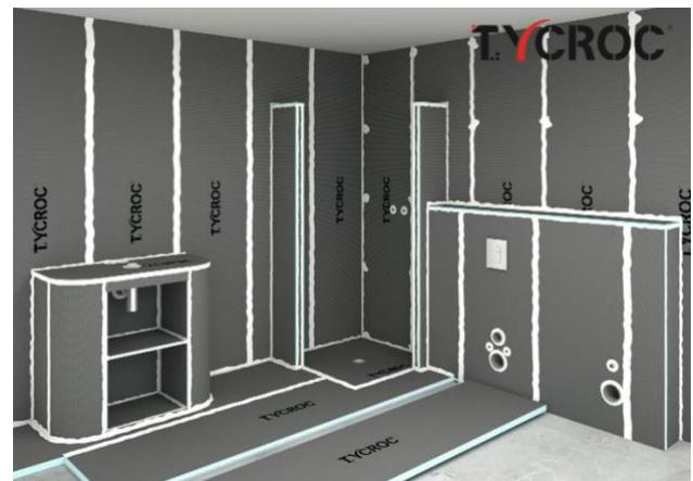
4.3 Уложить строительную плиту Тусгос TWP на пол и крепко прижать ее к поверхности либо весом собственного тела, либо с помощью дополнительного груза (например, мешком с клеевым раствором и т.п.). Перед установкой следующей плиты нанести на край предыдущей плиты клей-герметик Тусгос Premium FIX, чтобы склеить строительные плиты между собой.
