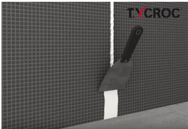
Используя шпатель, изолировать kleem-герметиком промежутки между строительными плитами, углы и другие проходы, покрыв им также крепежные шайбы. В душевом углу и других углах стена / стена или стена / пол, входящих в непосредственный контакт с водой, дополнительно использовать изоляционную ленту и гидроизоляционную мастику. Для изоляции торцов труб использовать клей-герметик Тусгос Premium FIX или, если проходы слишком велики, подходящую изоляционную манжету и гидроизоляционную мастику.
