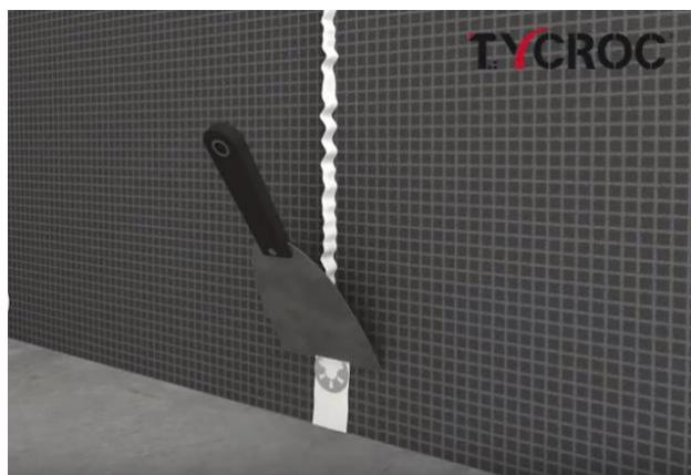
Используя шпатель, изолировать kleem-герметиком промежутки между строительными плитами, углы и другие проходы, покрыв им также крепежные шайбы. В душевом углу и других углах стена / стена или стена / пол, входящих в непосредственный контакт с водой, дополнительно использовать изоляционную ленту и гидроизоляционную мастику.
